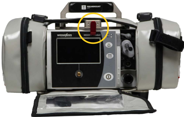
Figure 22: Retrait de l'appareil médical du BP380 – GR
