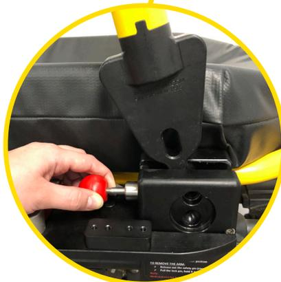
Dégagez facilement le Safety Arm System en enlevant la goupille de verrouillage tout en tirant et maintenant la poignée de sécurité
