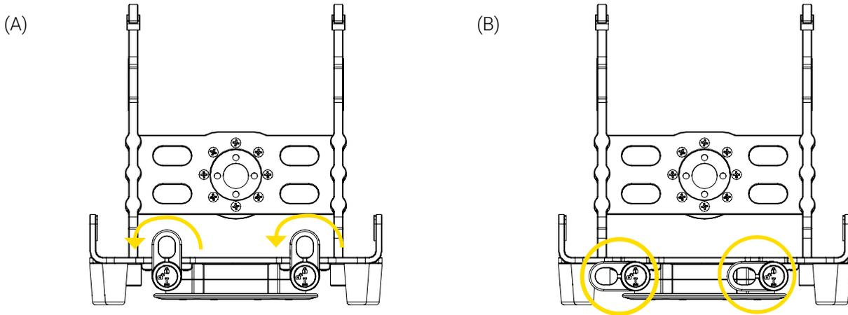
**Figure 2:** Déverrouillage du support Bracket Pro Serie 60 - GR
