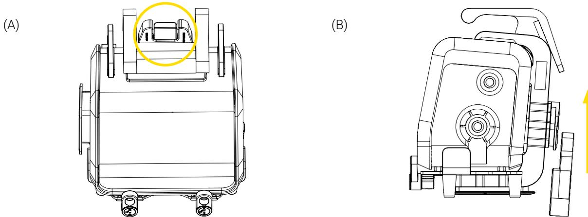
**Figure 8:** Retrait du support Bracket Pro Serie 60 - GR de la Micro Base
